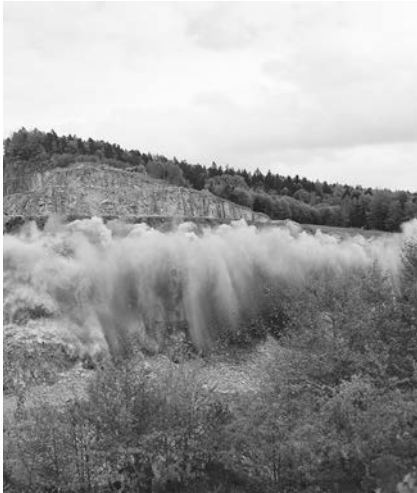
Sprengung bei den Kusser Granitwerken mit 15 Tonnen Flüssigsprengstoff (li.), Exkursionsteilnehmer (re.). Fotos: bayika
